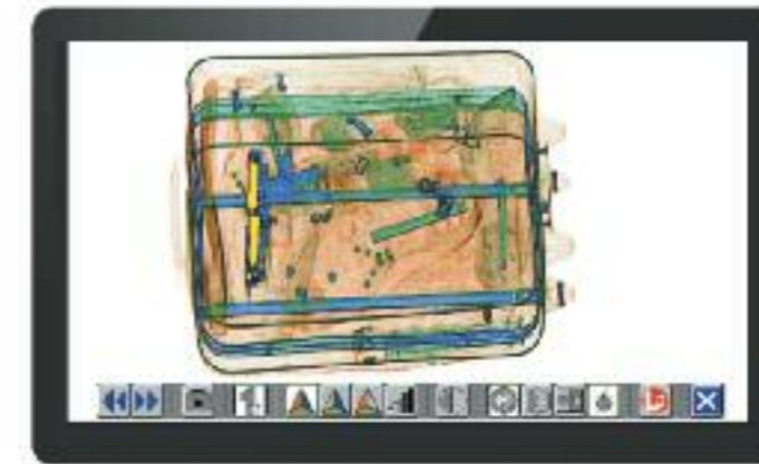
La interfaz del operador de L-3 es una pantalla táctil que permite una operación continua con alarmas que usan íconos que aparecen en la pantalla de visualización
